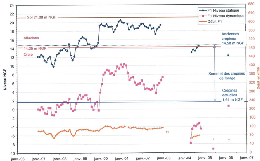
Figure 2 : Evolution des niveaux statiques, dynamiques et du débit sur le forage F1
